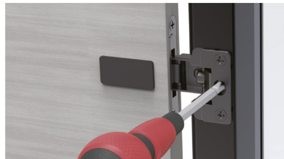
Regolazione laterale cerniera per porta con telaio in alluminio: da -2 a +0,5mm Lateral adjustment aluminum frame door hinge: from -2 to +0,5mm
