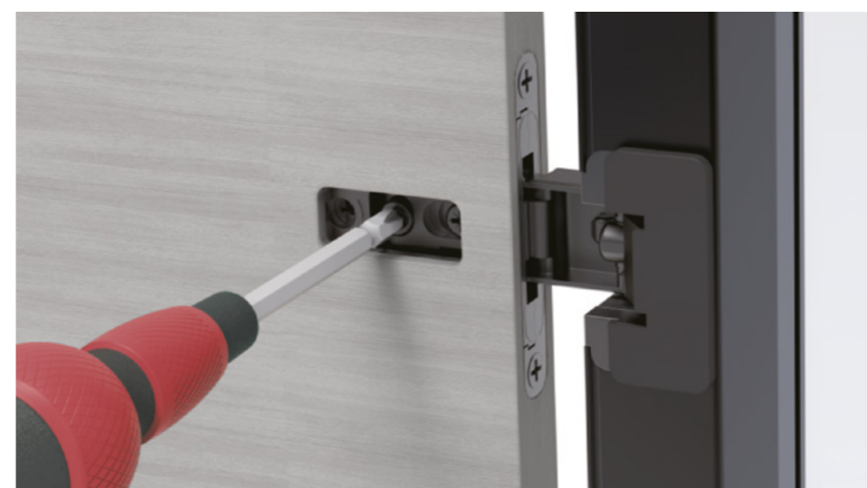
Regolazione profondità cerniera per porta con telaio in alluminio: da 0 a +3mm Depth adjustment aluminum frame door hinge: from adjustment: from 0 to +3mm
